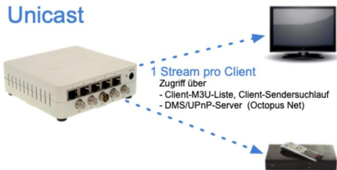
Die Octopus Net bietet vier unabhängige Tuner, so dass bei entsprechendem Anschluss auch Clients unterschiedliche Empfangswege nutzen können (DVB-S/S2+ DVB-C/C2 oder DVB-T/T2).
